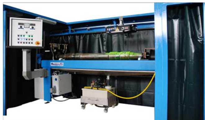
Abb. 2. Stromdurchflutung und Jochmagnetisierung mittels Felddurchflutung zur Prüfung einer Achswelle (Helling GmbH)
