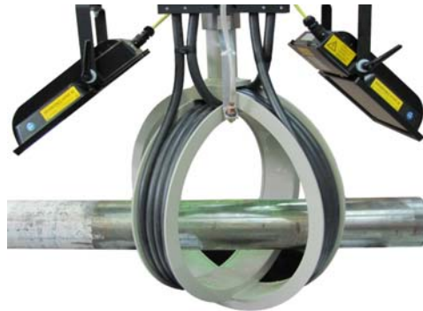
Abb. 7: Einfache Kreuzspule, mit einfacher Drehung des Prüfkörpers um 90^\circ kann man horizontale und vertikale Risse nachweisen.
