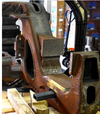
Abb. 3. Prüfobjekt Achsträger eines Güterwagens
