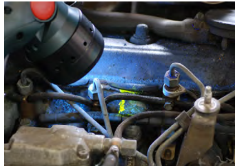
Dichtheitsprüfung am Kraftwagenmotor mit fluoreszierendem Konzentrat H 800
