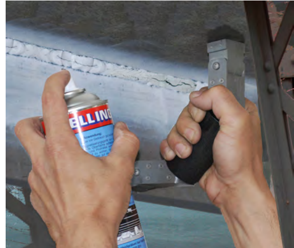
Schweißnahtprüfung mit schwarzer Magnetpulversuspension BW 333 und weißer Untergrundfarbe NR 104 A.
