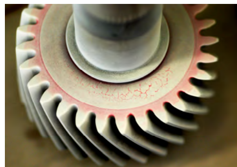
Fehleranzeige sichtbar gemacht mit Farb-Eindringssystem
